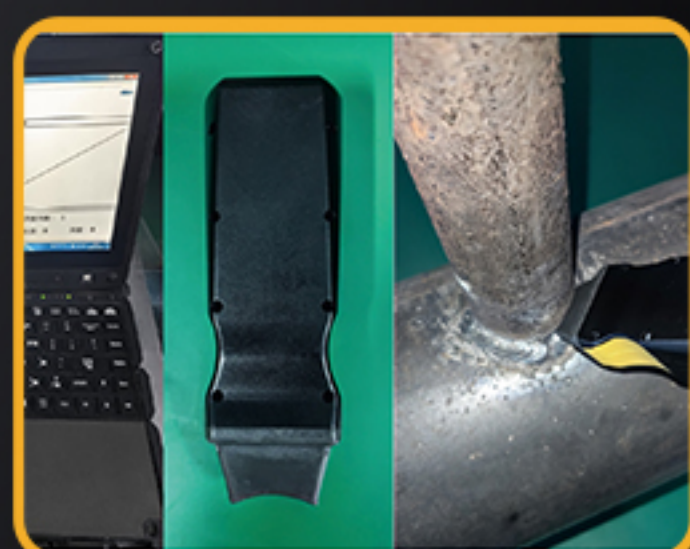
小接管检测 具备鞍型焊缝补偿算法 支持小接管焊缝检测
