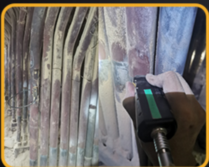
锅炉排管检测 具备多阵列数据独立处理算法 支持锅炉排管焊缝检测
