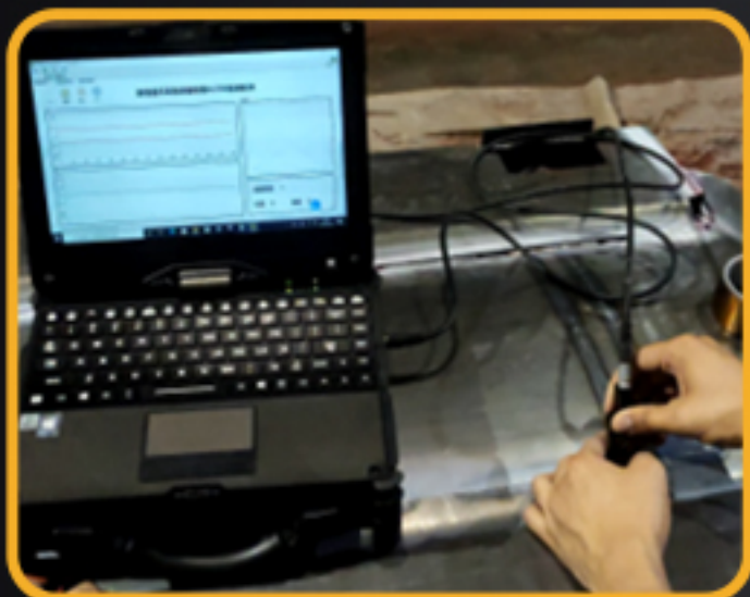
近表面缺陷检测 具备广域信号处理算法 支持聚焦探头
