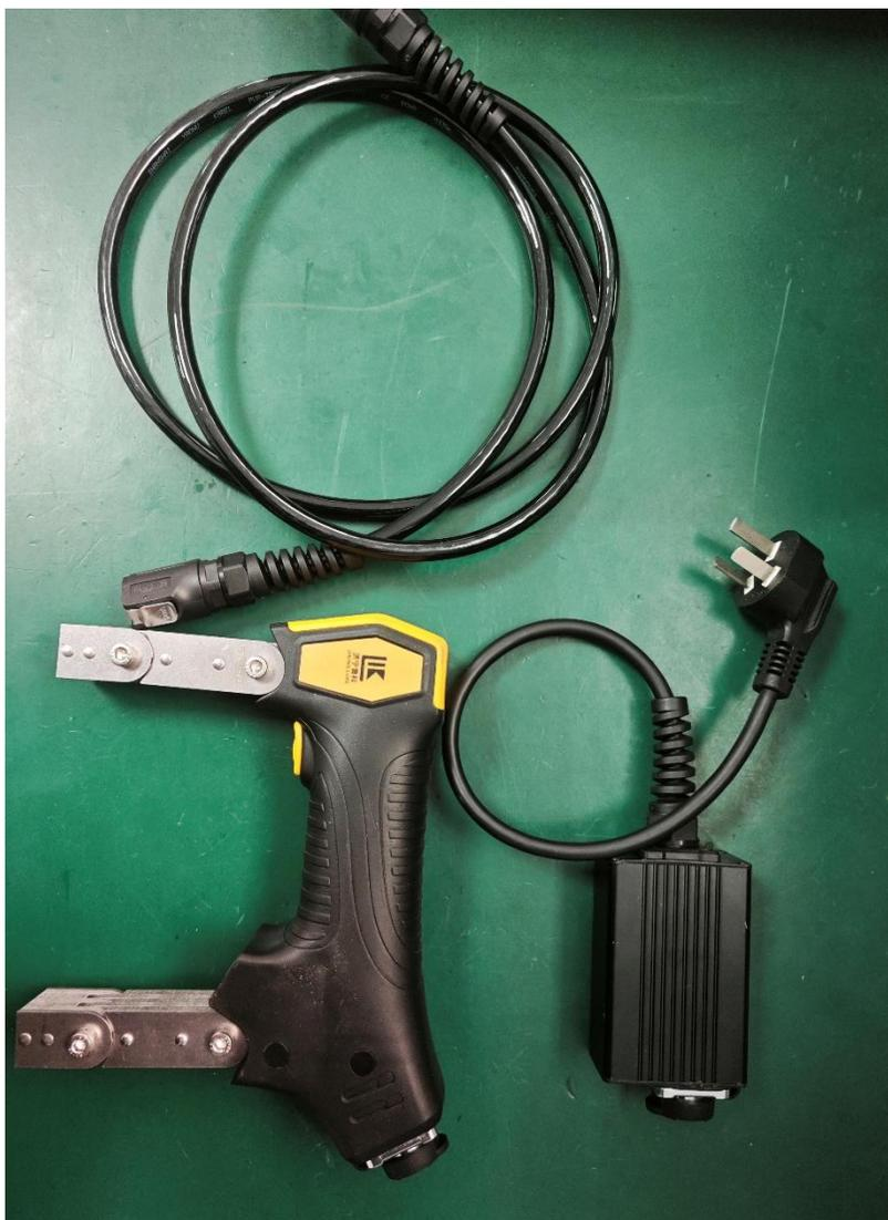
图 2: LKMT-VD6 选配“探头 220V 适配器”
