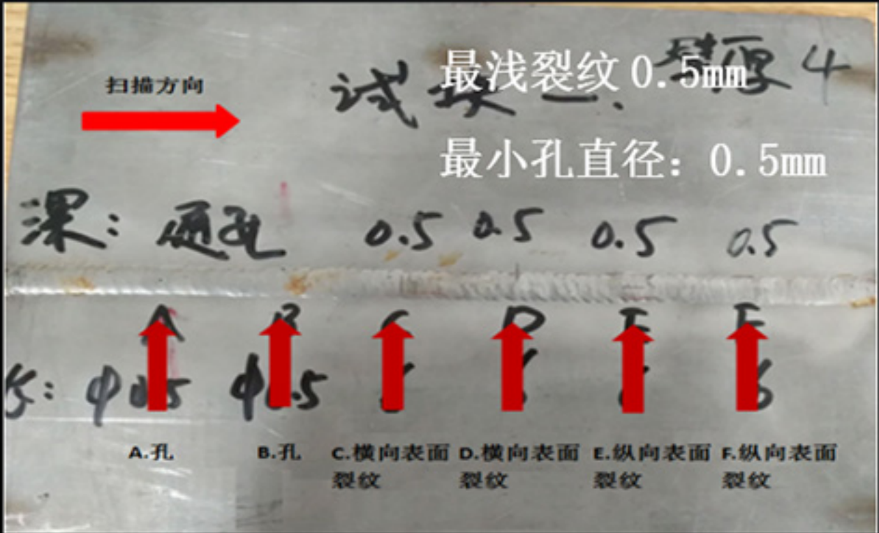
不锈钢焊缝中6个不同的缺陷
