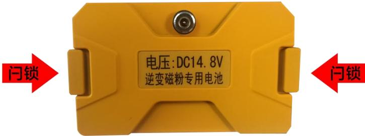
按箭头指示方向按压电池卡扣，即可将电池抽出或推入。注意更换电池后要确认电池组两边卡扣回弹到卡槽内，从而防止未锁住造成电池接触不良或电池组脱落。
